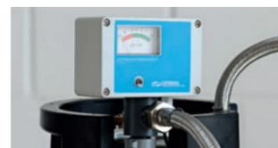
Einsatzbereite Edelstahlpatrone mit aufgeschraubter Leitfähigkeitsmessung
