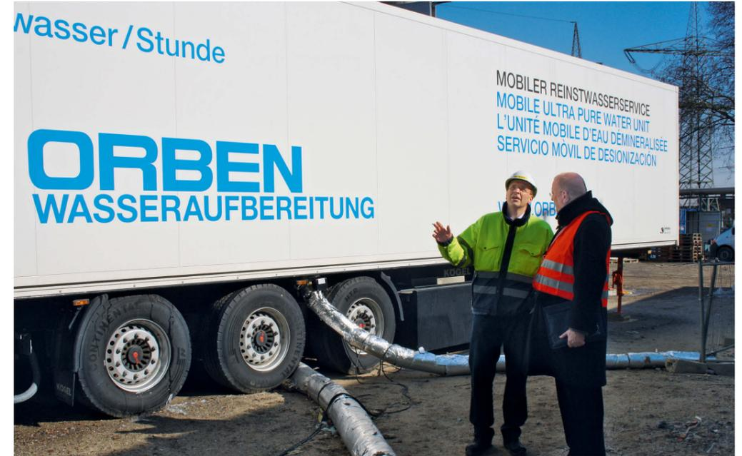
Die auf einem Sattelanhänger installierten Anlagen sind mit hochmodernen Komponenten der Wasseraufbereitung, wie Ultrafiltration, Konditionierung, Umkehrosmose und Membranentgasung ausgestattet. Nachgeschaltete Mischbetten gewährleisten einen Leitwert < 0,1 µS/cm. Das aufbereitete Wasser entspricht den relevanten Qualitätsanforderungen der VGB-Richtlinien und des VdTÜV.
